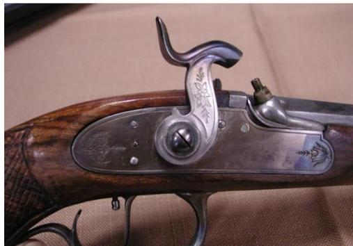
Abbildung 10 Links das Schloss des Stutzers von Michael Scheitlin, rechts zum Vergleich ein Le Page Perkussionsschloss mit Hahn in Laderast
