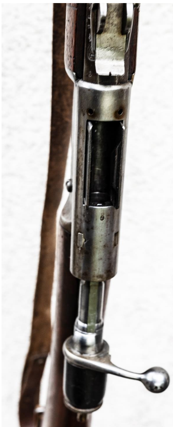
Verschluss des Vetterli-Gewehrs 1871
